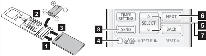
1 ~ 3 Coloque las baterías tal y como se muestra en la figura de arriba.
