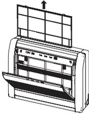
2. Instale el conjunto del filtro de limpieza de aire (formado por 2 filtros).
